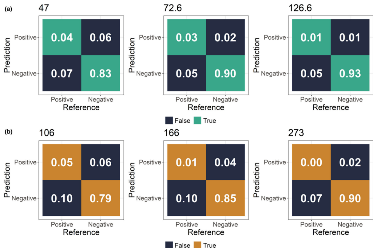
Afbeelding 3 - verschillende confusion matrices van de twee modellen zoals getoond in het paper van de UvA (Bradarić, Kranstauber, Bouten, & Shamoun-Baranes, 2024). De matrices voor het voorjaarsmodel (a, groen) en het najaarsmodel (b, oranje) tonen het deel van de resultaten dat goed en fout voorspeld was voor verschillende drempelwaardes van het model. Voor doeleinden van ons systeem zijn de twee meest rechtse matrices het meest relevant, aangezien die dichtst in de buurt komen van de drempelwaardes die gehanteerd zouden worden in productie.
