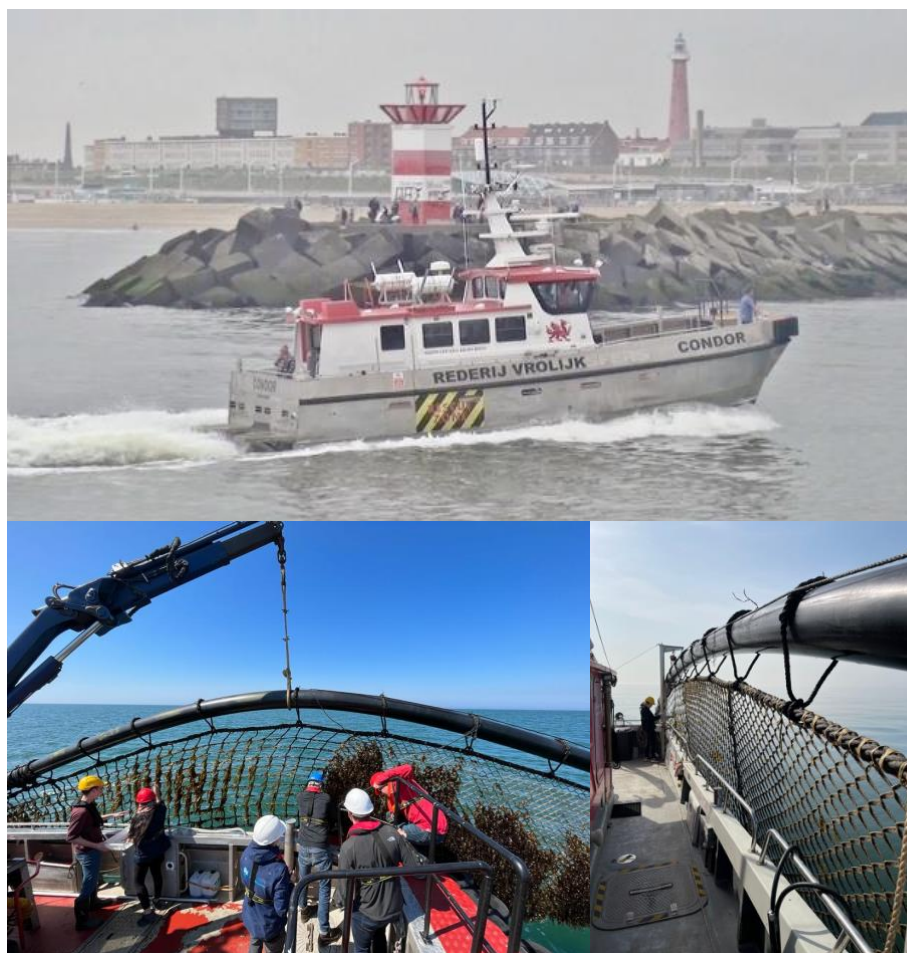
Figuur 10: Voorbeeld van een inspectie met een kleine CTV met kraan
