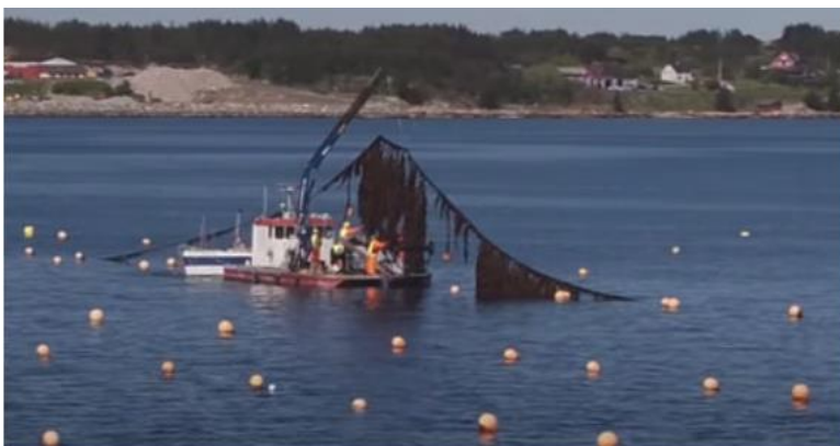
Figuur 2-18 Oogstmethode van zeewier waarbij d.m.v. een kraan op een klein schip [Ref 20.]
