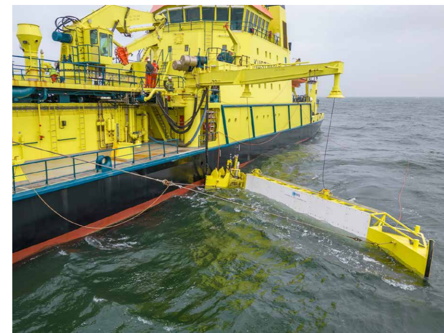
De MS Arca heeft aan beide kanten van het schip een 15 meter lange veegarm waarmee olie opgeruimd kan worden.
