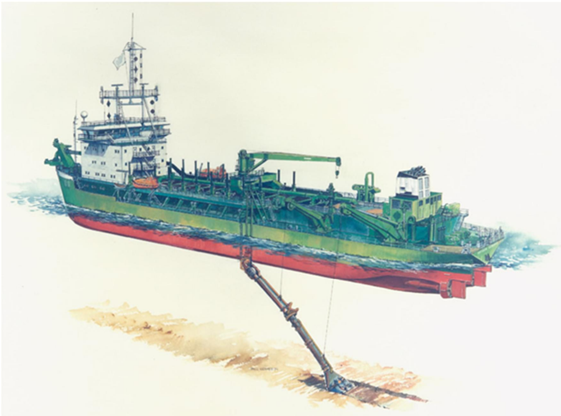
Figuur S.4 Afbeelding van een sleehopperzuiger (Bron: edugis.nl)
