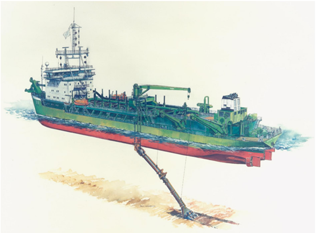
Figuur 5.2 Afbeelding van een sleephopperzuiger (Bron: edugis.nl)
