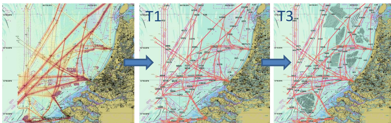
Figuur 3-2 Proces van het opbouwen van de verkeersdatabase (links AIS-data met de route structuur, midden situatie met alleen de groeifactoren toegepast, rechts situatie inclusief de aanpassingen van de routestructuur)
