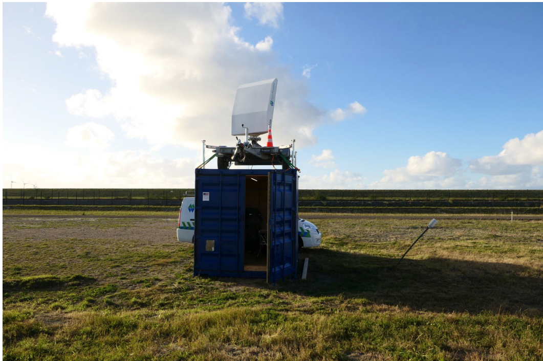
Figuur 2.1 3D-vogelradar MAX®. Het weerstation dat aan het radarsysteem is gekoppeld is hier bevestigd op de pilon.
