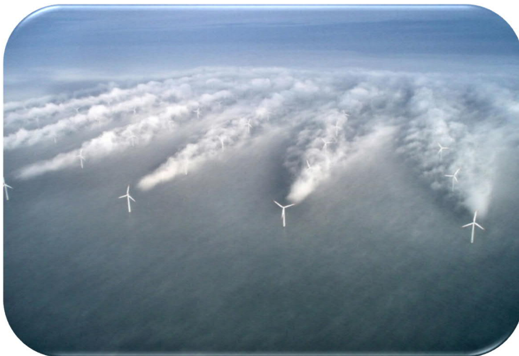
Effect van turbines op luchtlagen (Horns Rev III, Denemarken)
