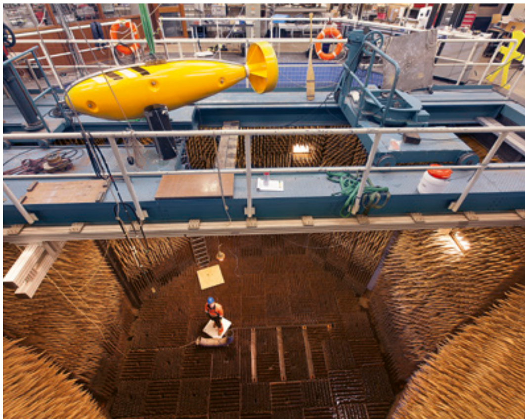
Het akoestisch meetbassin van TNO dat normaliter water bevat, om onderzoek naar onderwatergeluid te doen.
