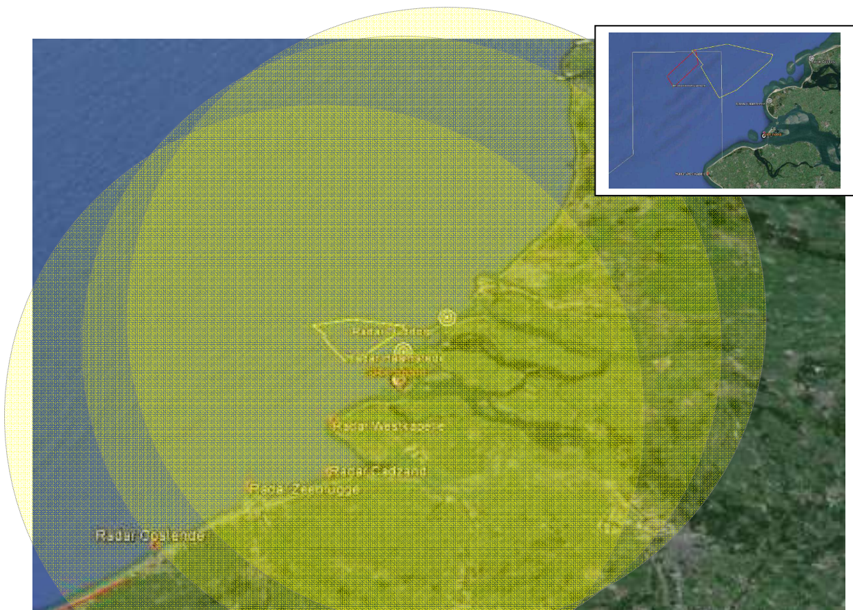
Figuur 17b. LoS bereik van de huidige SRK radarstations, bij een masthoogte van de windturbines van 100 m
