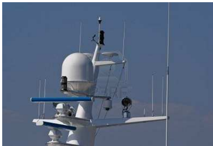
Figuur 74. Typische scheepsmast met radarantennes en communicatieantennes
