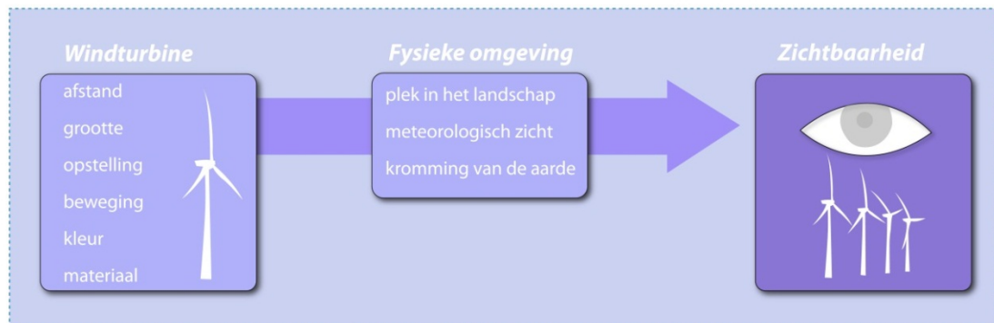
Figuur 11: Relatie tussen de karakteristieken van windturbines en de fysieke omgeving en de invloed op zichtbaarheid
