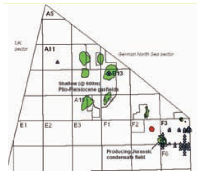
Figuur 3.3: Het voorkomen van een pockmark (rode Stip) en gasontsnappingsen, of gasfonteinen (blauwe driehoeken), in het noordelijk deel van het NCP (Bron: C. Laban, TNO-NITG).
