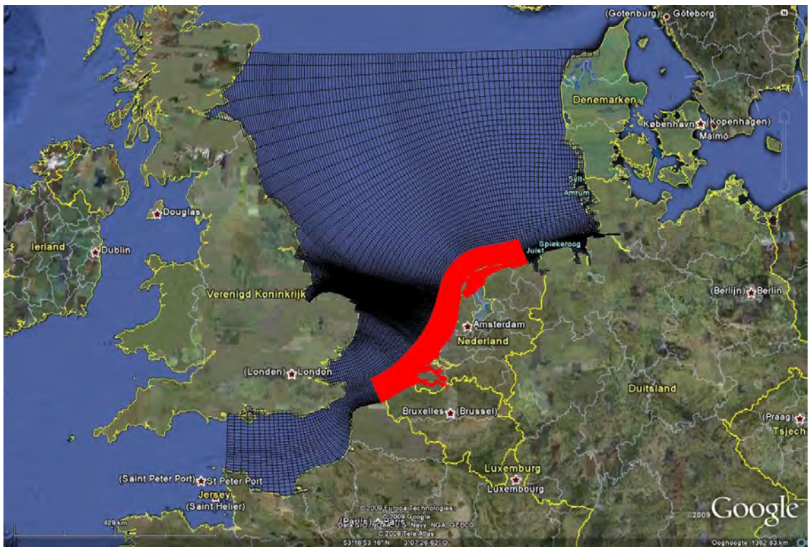
Figuur 2.3 Rekenrooster ZUNO-fijn model (zwarte lijnen) dat gebruikt is voor het afleiden van de randvoorwaarden van het NCM model (rode lijnen).
