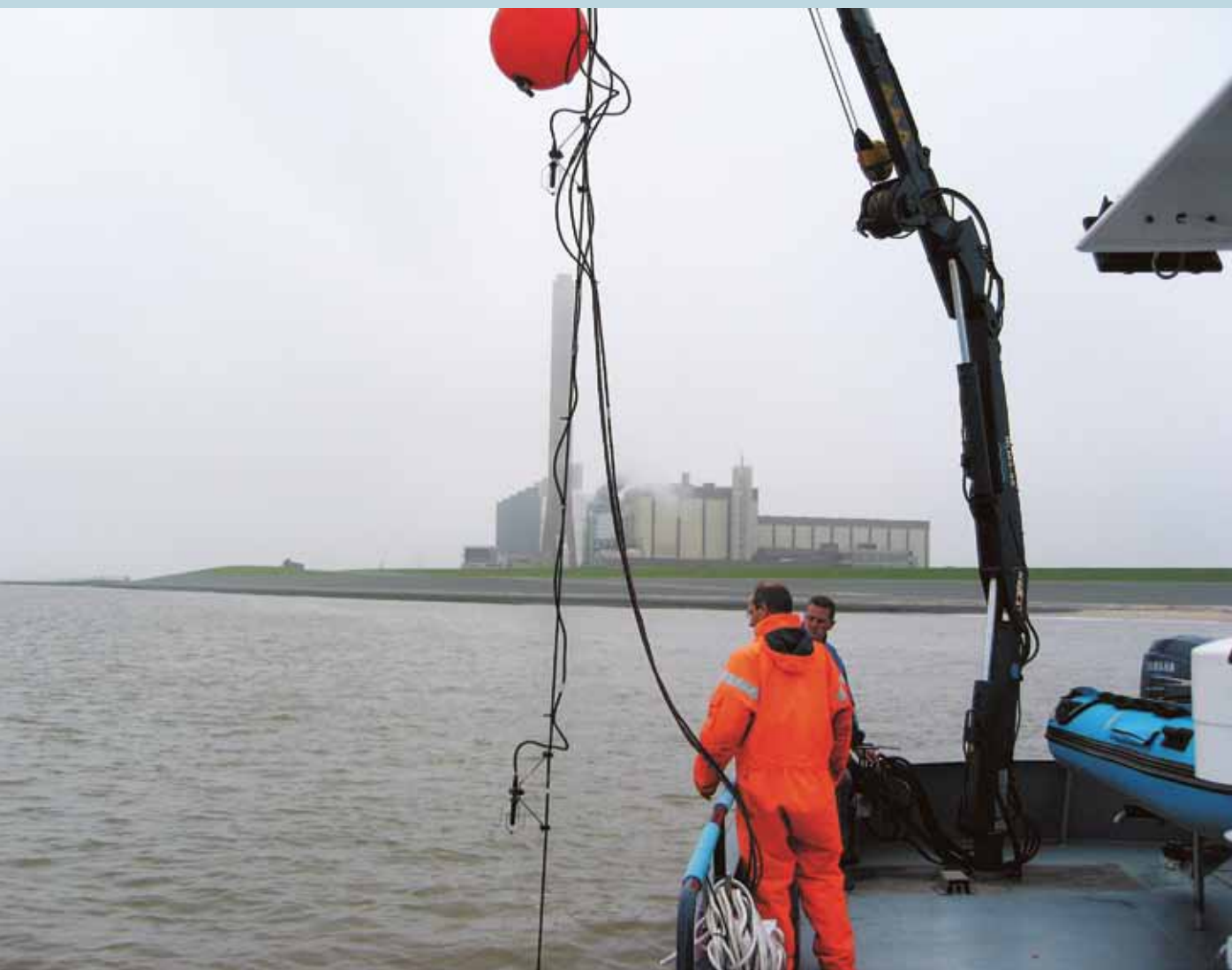
Toepassing van hydrofoonarray voor onderwatergeluidmetingen (bron: TNO)
