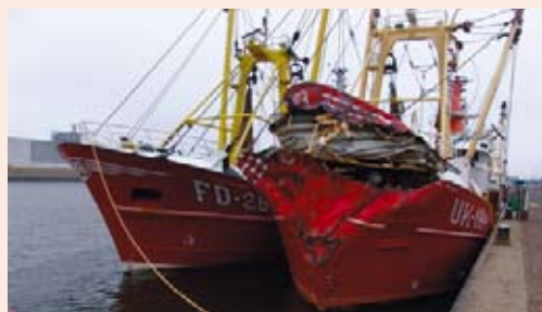
Schade aan de boeg van de UK 184
